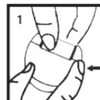
1. Как показано на рис.1 и рис.2, одной рукой удерживайте головку изделия, а другой нажмите кнопку замены шлифовальной головки. Извлеките шлифовальную головку.
