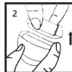
2. При замене шлифовальной головки вставьте в изделие новую шлифовальную головку до тех пор, пока не услышите звук "щелчок". Убедитесь, что только что установленная шлифовальная головка установлена ровно. Если шлифовальная головка установлена не ровно, не нажимайте кнопку устройства. Снова извлеките головку и установите ее ровно. Примечание: одна шлифовальная головка уже установлена заранее на производстве.
